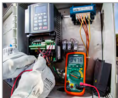
El filtro de paso bajo (LPF) garantiza mediciones precisas de voltaje de CA en una unidad de frecuencia variable.
