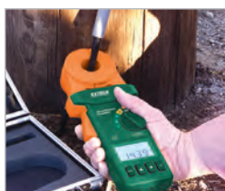
Verifique la resistencia de las redes de tierra de torres celulares y de comunicación
